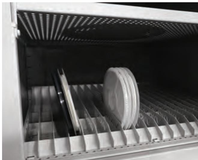
Lagersystem für SMD-Rollen wird auf einem Standardfachboden im Trockenschrank montiert und ermöglicht die Auswahl bis zu 3 Reihen für die Lagerung. Rollendurchmesser liegt zwischen 85 und 215 mm und die minimale Breite einer Zelle beträgt 27 mm
