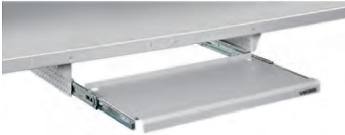
Die Tastaturplatte ist zum leichteren Gleiten mit einer Ausziehvorrchtung versehen. Das Plattenmaterial ist mit dunkelbrauner (RAL 7012) oder hellgrauer (RAL 7035) Pulverlack beschichteter Stahl. Die Platte ist für alle Tischtypen geeignet, sie kann an allen Arbeitsplätzen mit einem über 616 mm breiten und 383 tiefen Freiraum unter der Tischplatte montiert werden.
